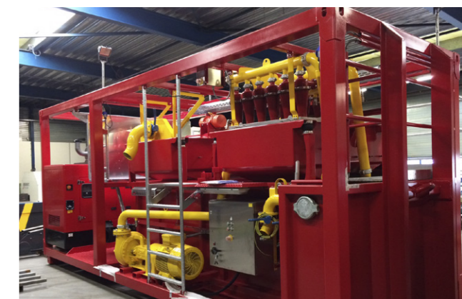
R1000EG 1000 l/min | Generatore integrato | Sistema sollevamento multiplo integrato
