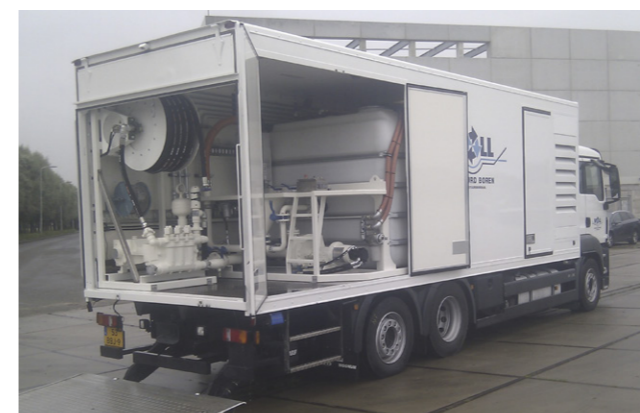
MP502DH 500 l/min a 70 bar | Integrata su autocarro | Serbatoio extra da 3000 l
