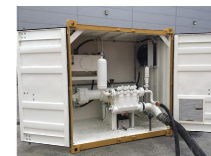
P1000DH 1000 l/min a 50 bar | 3000 x 2300 x 2400 mm (LxLxA) | 6500 kg
