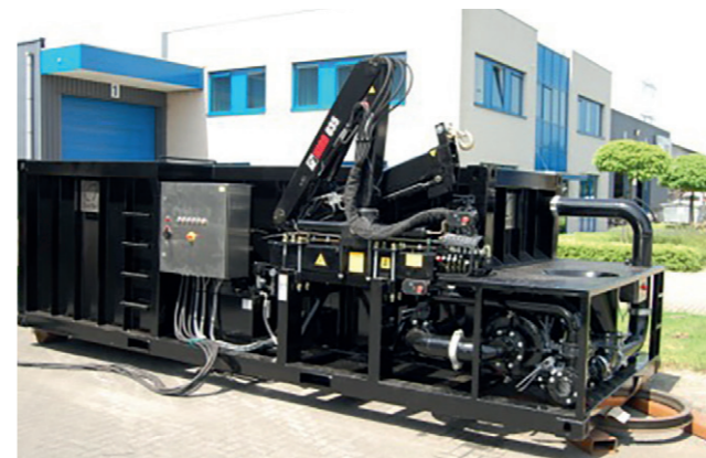
M1000EC 1000 l/min | Contenitore ISO 20 ft | Gru completa 6,5 t
