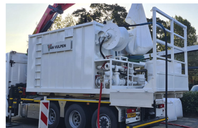
MP750DH 750 l/min a 70 bar | sistema sollevamento multiplo integrato
