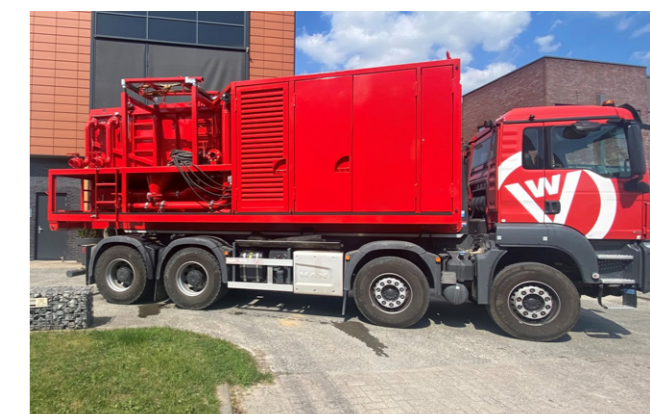
MP1000E 1000 l/min a 70 bar | sistema sollevamento multiplo integrato
