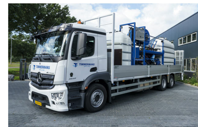
MP250DH 250 l/min a 70 bar | Costruita su autocarro | Serbatoio extra da 3000 l
