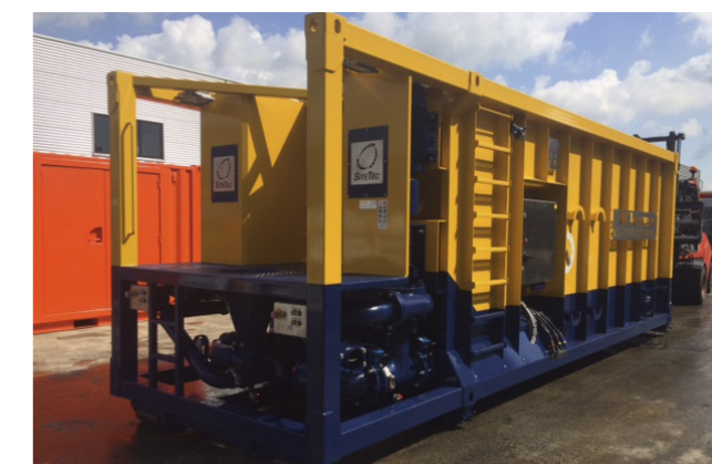
M2502E 2500 l/min | 7200 x 2450 x 2600 mm (LxLxA) | 9500 kg
