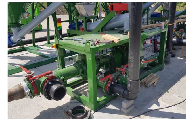
MT8x6E tavola di miscelazione con pompa centrifuga 8 x 6 x 14 Amteq
