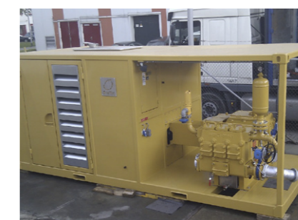
P1000D 1000 l/min a 70 bar | 5000 x 2300 x 2400 mm (LxLxA) | 8500 kg
